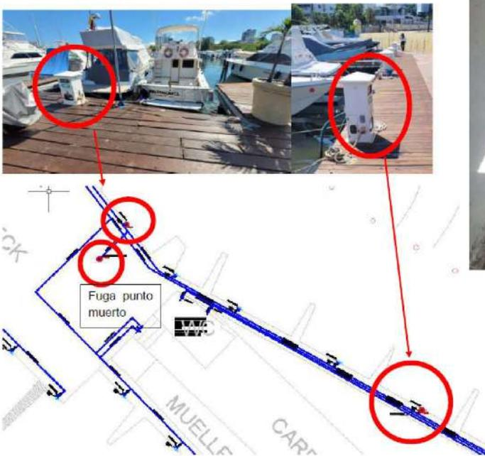
Ilustración 1 Medidores con fuga en Muelle 1
